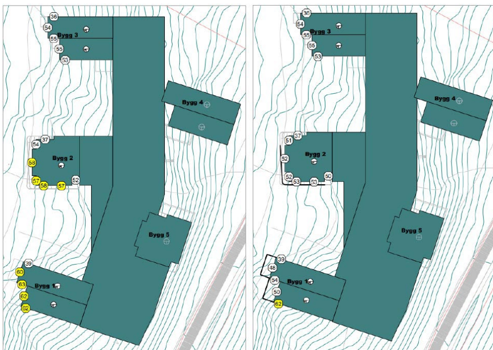
Ill. 7.23. Bygg i nordre område uten skjerming t.v. og med 1,5m høy skjerming t.h.
